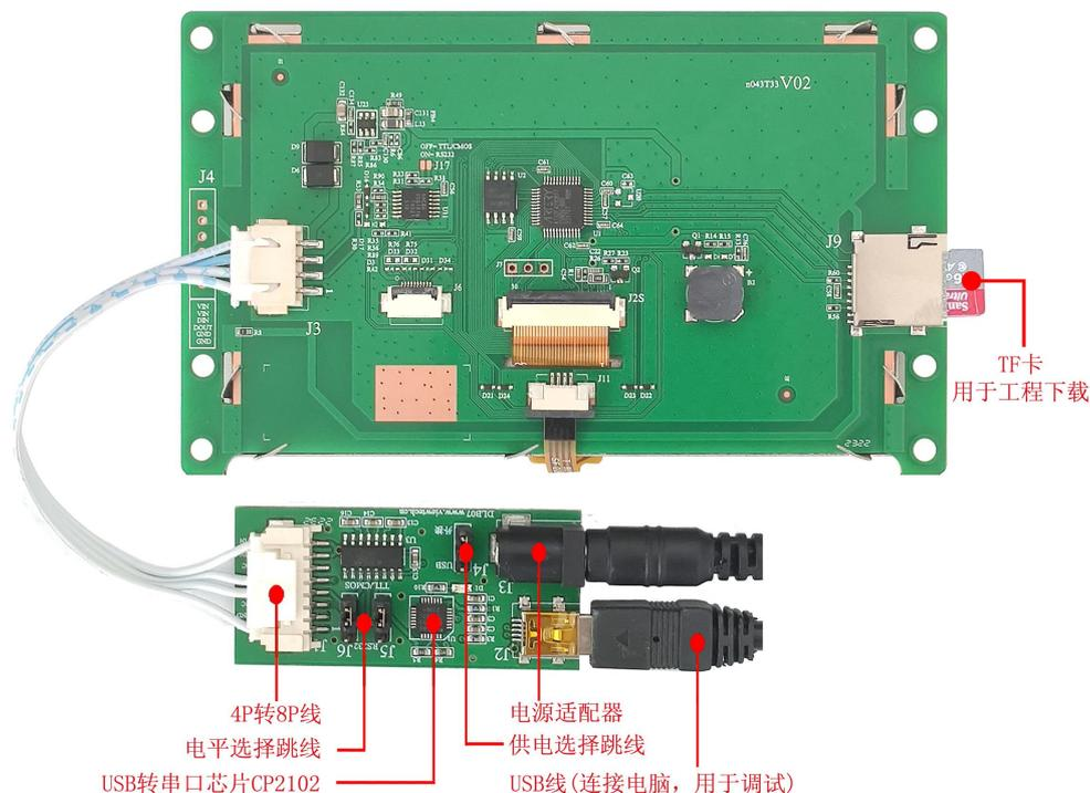
图 3 调试工具连接示意图
