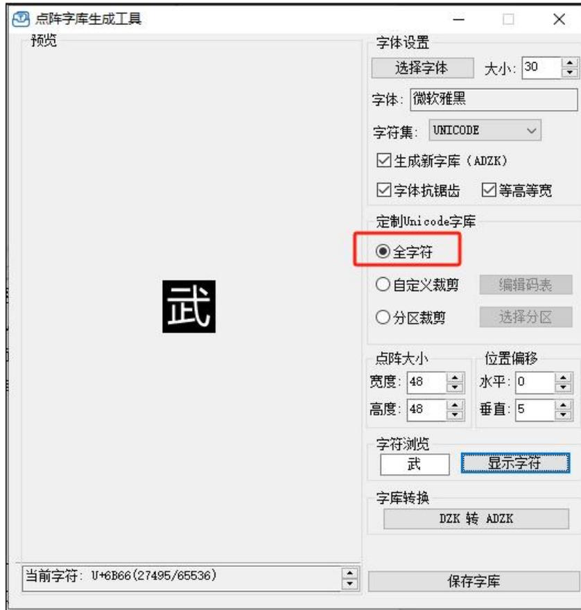
图 7.制作 Unicode 全字符字库点阵字库生成工具设置
